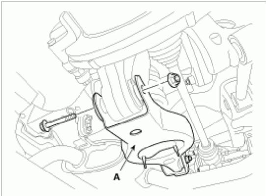
4. 拧下螺栓与螺母，拆卸后下摆臂(B)与副车架(A)。
